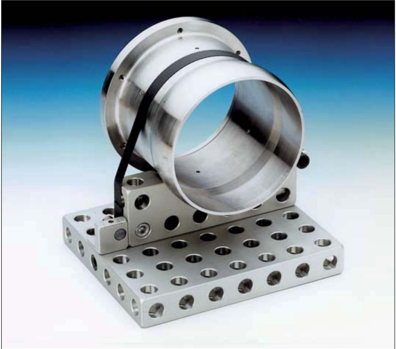
Utilisation d'un bloc en V avec bridage par bande
