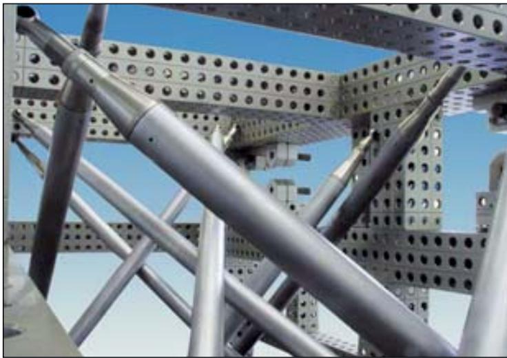
Les renforts ajustables développés par Witte se composent d'embouts à tête sphérique et de corps. Cette conception originale permettant de faire varier longueur et angle d'utilisation offre des possibilités variées d'assemblage.
